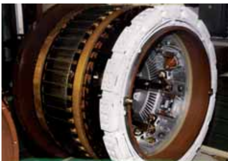
Büstenlose Erregermaschine mit Schutzbeschriftung und PMG Brushless exciter with protection device and PMG
