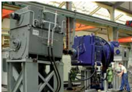
5 MW Asynchronmotor für Getriebeprüfstand 5 MW induction motor for gear test bench
